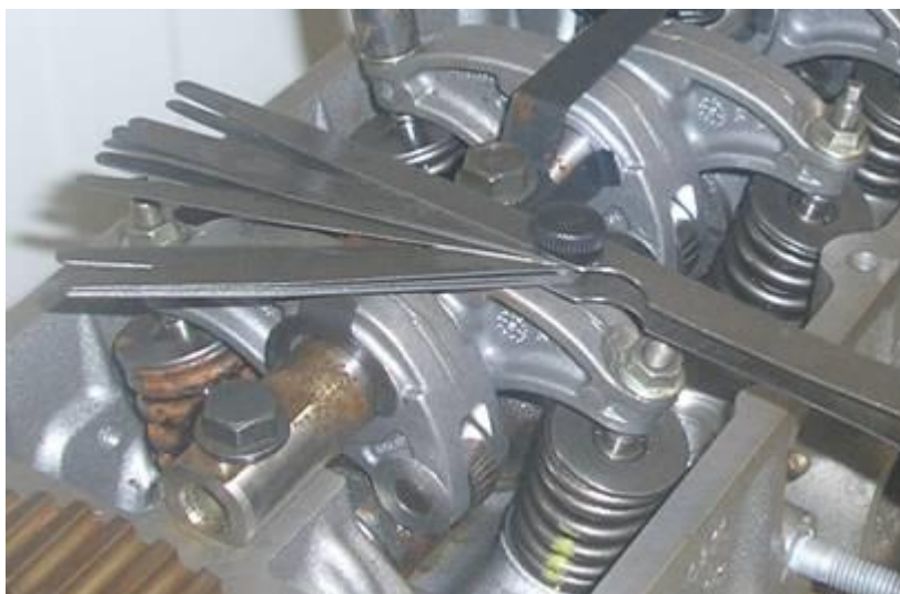
Reglarea jocului dintre supapa si culbutor (motor K4M)
