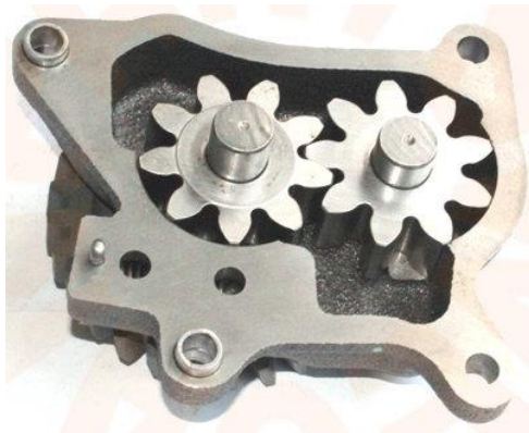
Foto: Pompă de ulei cu roți dințate cu angrenare interioară
