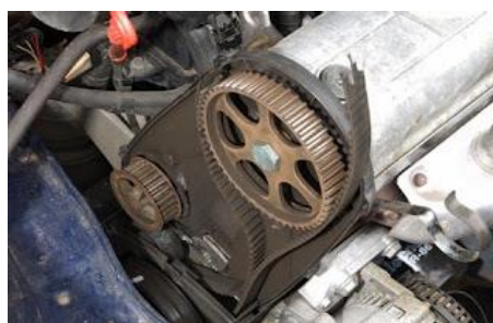
Curea de distributie rupta
